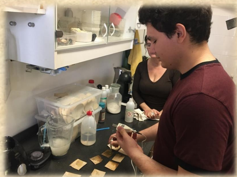
Zsolt a régi papírok kémhatását méri egy hordozható pH-mérő segítségével.
